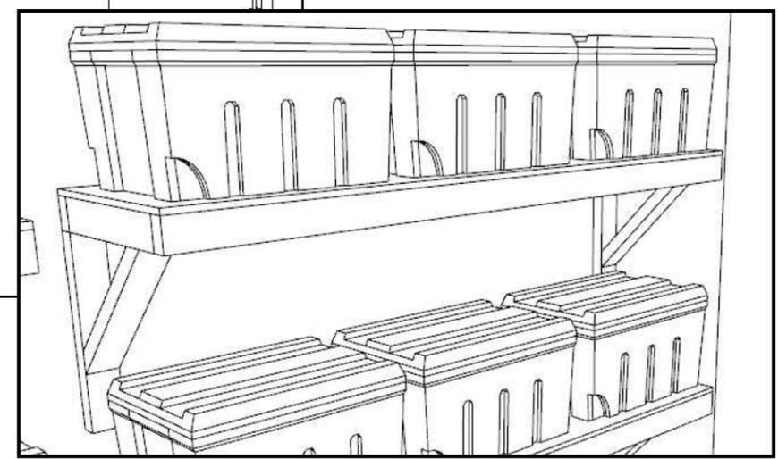
Tablettes faites avec équerres de 2x4 et frame en 2x4
