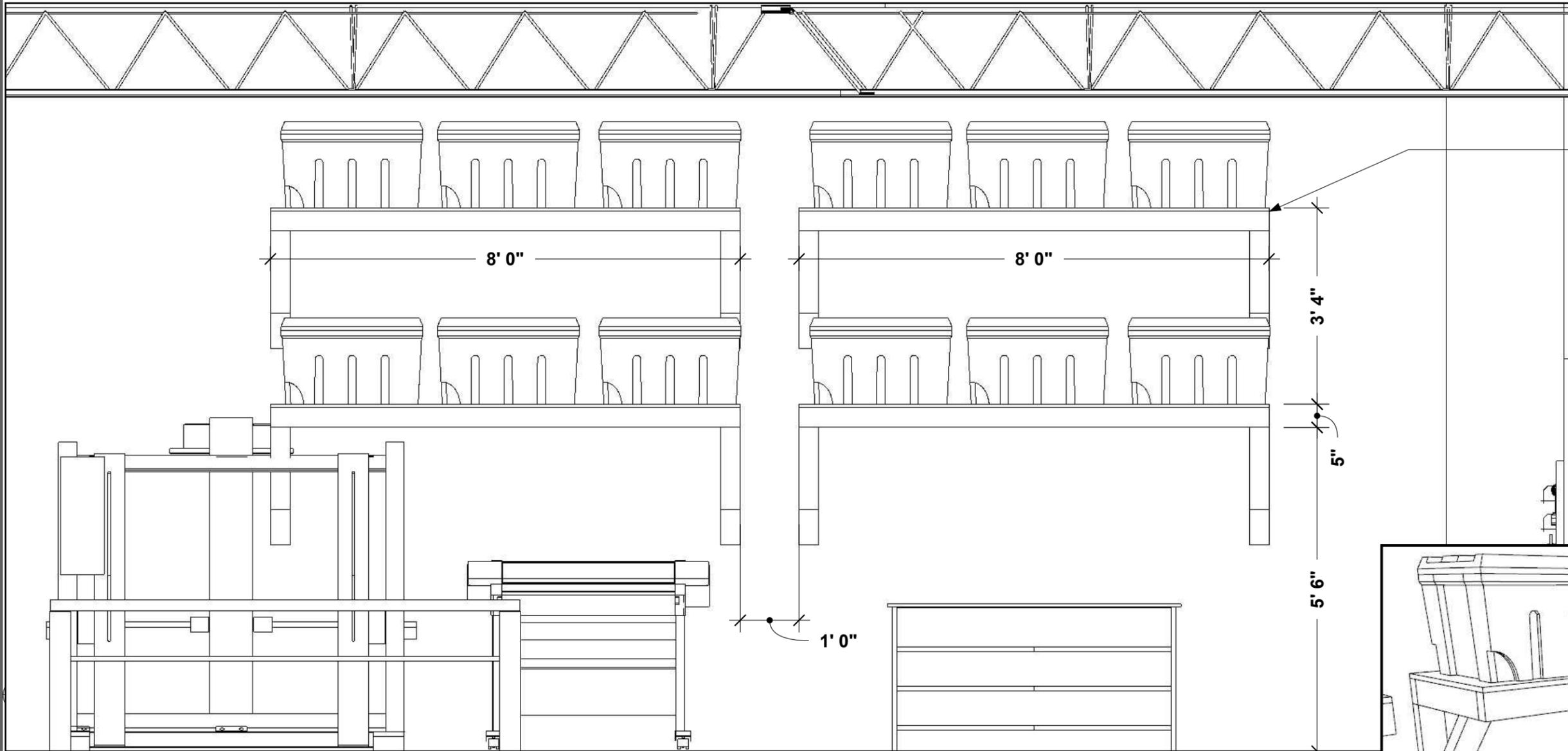
Tablettes de 24" de profondeur en 2x4 avec contreplaqué 3/4 sur le dessus
